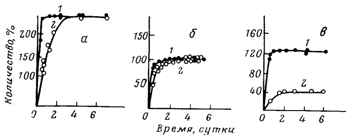
Рис. 8. Кинетические кривые поглощения полимерами из жидких (1) и парообразных (2) сред 301 : а, б — неинертных, в — «инертных» веществ; а — непористый сополимер стирола с 6% ДВБ — бензол; б — макропористый сополимер стирола с 20% ДВБ — бензол; в — макропористый сополимер стирола с 20% ДВБ — метанол
